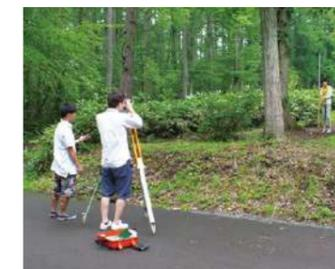
1年次の夏季休業期間中に、4泊5日の日程で野尻湖セミナーハウスにて合宿で行う実習です。前期科目の測量学で修得した基本的な測量技術を総合し、実際に地形図を作製します。この実習を通じて、測量学の基本技術を用いる方法について学修すると同時に、共同生活を通じてお互いに刺激を与え合い、また、相互理解を深めることを目的としています。
