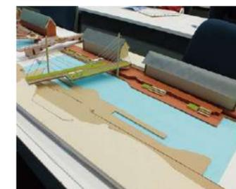
1年次「デザインの基礎」や2年次「構造力学1,2」を受けて、橋のデザイン企画と設計計算書の作成に挑戦します。実際のデザインコンペの要求条件を再現して、班に分かれてオリジナルのデザインを提案します。場所の環境や歴史なども調べて、核になるコンセプトを構築し、また力学的観点から強度が保たれているかの証明も要求されます。
