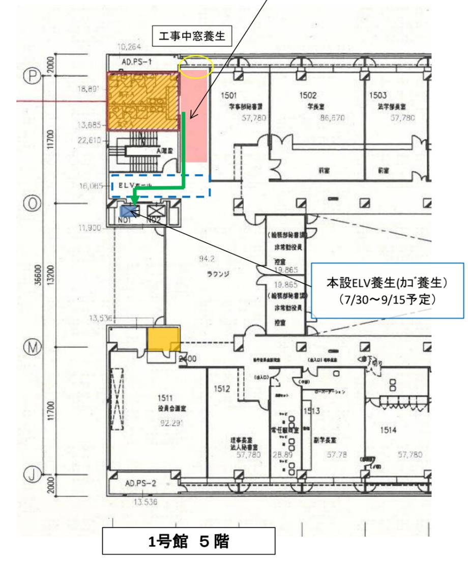
1号館3階5階平面図・配置図
