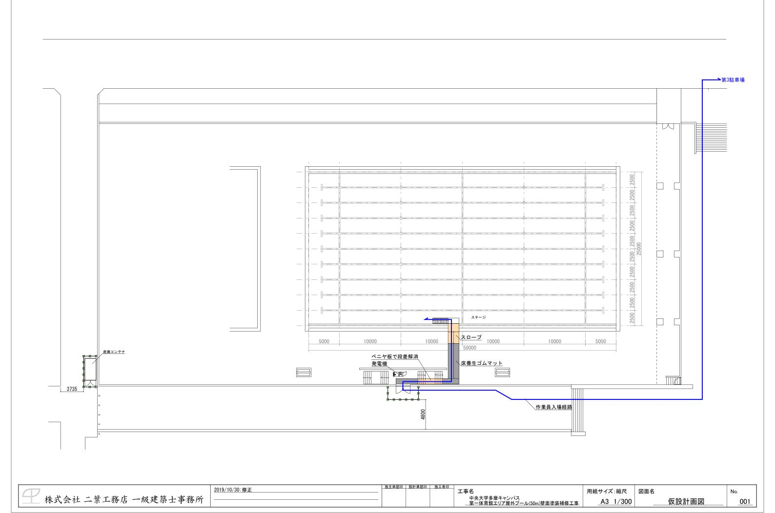
自 2019.11.5. 作成 2019.10.15. 至 2020.3.13. 修正 2019.10.15. 工事名:中央大学 多摩キャンパス 工期: 第一体育館エリア屋外プール(50m)壁面塗装補修工事 アスペスト含有検査 会議・検査 プレハブ・発電機・床養生 仮設工事 既存塗膜除去 ひび割れ補修 高圧洗浄 資材搬入 下地調整 I (壁面) 下地調整Ⅱ(壁面) プライマー塗布(床面) タックコート・レジモル(床面) 目止め(床面) 面調整(床面) 下塗り(壁面) 中塗り(床・壁) 上塗り(1回目)(床・壁) <u>:</u>塗り(2回目)(床・壁) コースライン引き
