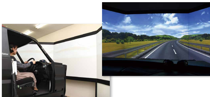
▲キーを回して、サイドブレーキを下してギアをDに入れて開始。アクセルの開き具合と画面の流れ方などが完璧に合っており、本物のトラックに乗っているよう。
