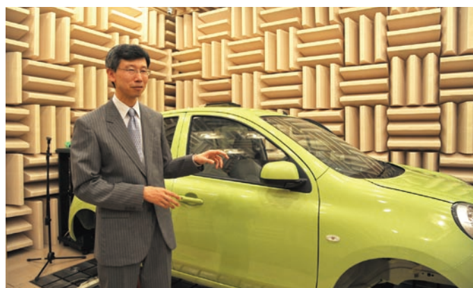
▲自動車のボディを使ってスマートサウンドスペースの研究を推進。「半無響室」には機器を固定する定盤が備えられているなど、設備の充実度も高い。
