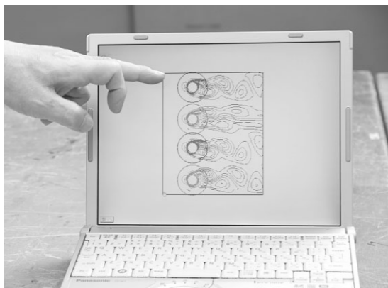
原子力発電所で使われている熱交換器を再現したシミュレーション。配管のまわりの流体がつくる渦が、装置にどのような影響を与えるのかを検証するためのものだ。
