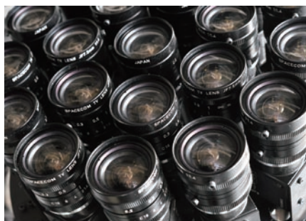
▲コンピュータショナルフォトグラフィで使う写真を撮影するためのカメラ。この1台に21個のレンズが装着されている。安定的にバーチャルな画像を生成するためには、レンズが奇数台であることがカギとなる。
