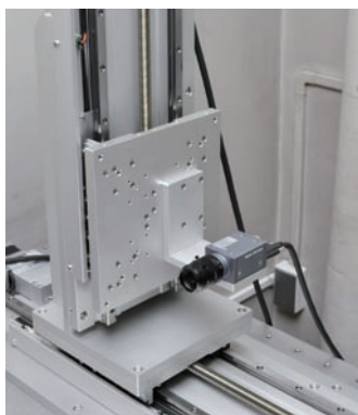
◀▲カメラを垂直・平行移動させて、同一の物体を複数の位置・角度から撮影する機械（左）と、取得したデータで久保田先生が作成した3D画像（上）。
