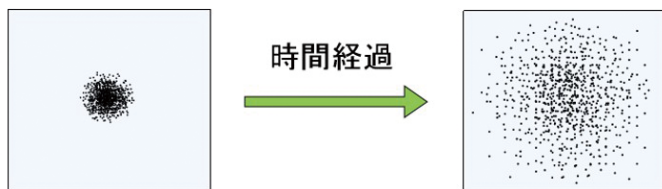
▲物質の拡散のイメージ図。あるポイントに集中していた物質が、時間の経過とともに広がっていく。
