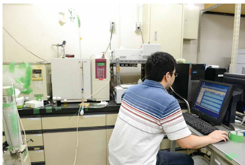
▲拡散現象の計測に使われる装置。超臨界二酸化炭素を入れた状態の内部に物質を注入し、外に出てくるまでどれ位の時間がかったかを調べる。
