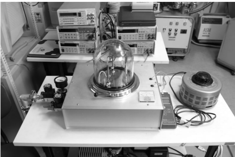
試料加熱用真空装置。通称、アニール装置と呼ばれる。これは、卒業研究生が製作した。研究室には、この他にも手製の装置がたくさんあった。
