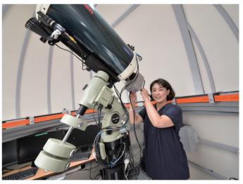
▲6号館屋上にある天体望遠鏡。坪井研究室では、すざくX線天文衛星などと同じ星を見て、X線と可視光のデータを同時に取得している。
