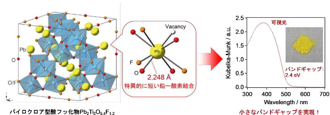
図 2. パイロクロア型酸フッ化物 \text{Pb}_2\text{Ti}_2\text{O}_{5.4}\text{F}_{1.2} の結晶構造と光吸収特性
