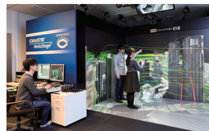
3面スクリーンの「バーチャルリアリティ装置」都市の防災・環境シミュレーションの結果を立体的に可視化し、快適で安全な都市空間の計画・設計を行うシステムを構築しています。
