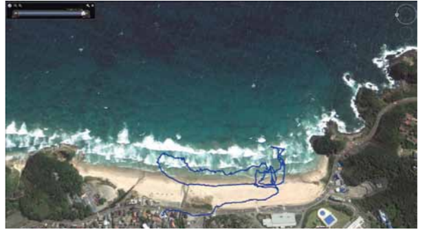
GPS(全球測位システム)被験者による海浜流の計測結果の例 / 海水の流れや波の状況を知ることで自然のメカニズムを学ぶ。特に、溺水事故の主要因である離岸流(海岸の波打ち際から沖合に向かって生まれる潮流)を計測する。
