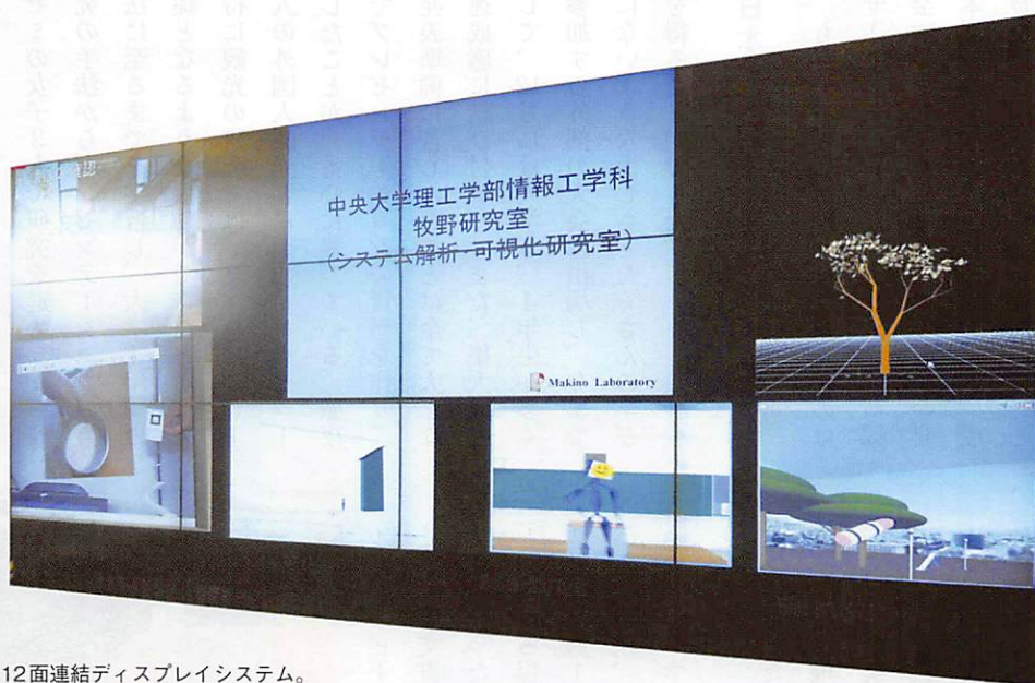
研究室にある12面連結ディスプレイシステム。 4Kを超える画像・映像を人間サイズで表示できる他、ARシステムも搭載。
